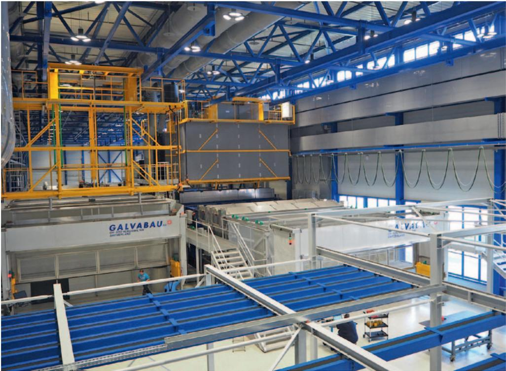
Die Anlage ist zweireihig konzipiert und ca. 60 m lang – bei einer Breite von rund 21 m wird eine Höhe von ca. 11,5 m erreicht. Das nutzbare Warenfenster beträgt 7,0 x 2,3 x 1,0 m (B x H x L). Das Badvolumen einer einzigen Spülwanne beträgt rund 28000 Liter. Zum Vergleich: In einer Badewanne kommen ungefähr 140 l Wasser zum Einsatz.
